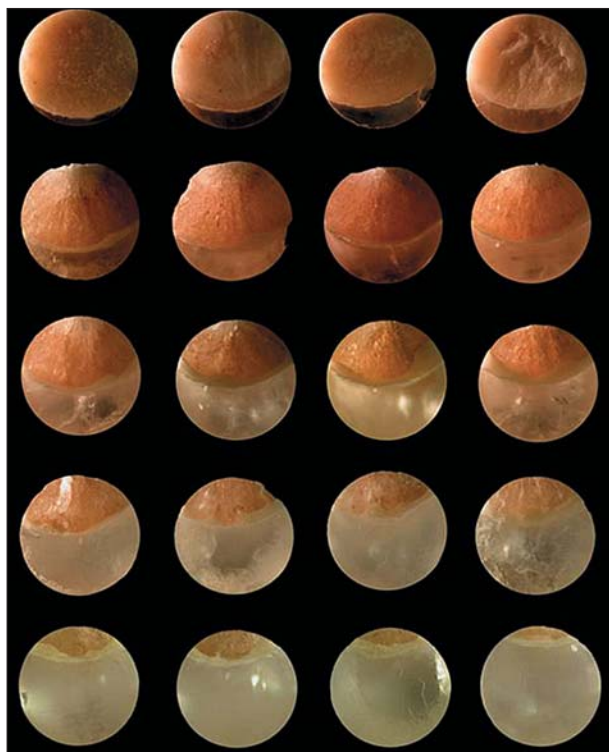
«Лунный» керн: фотографии торца керна, сделанные примерно через каждые 0.5 м в интервале 3042—3052 м (при повторном бурении ось скважины отклонилась от оси основной скважины, и поэтому доля чистого льда в керне неуклонно увеличивалась с глубиной).
