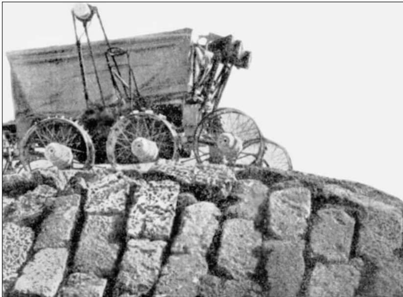
Испытания «Лунохода-1» в наземных условиях, имитирующих лунный грунт.
